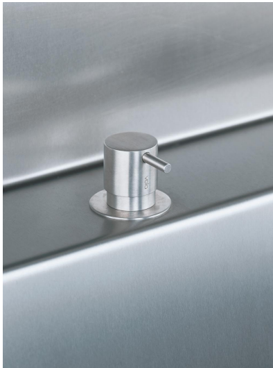
S50 Stopkraan 1/2", met keramisch cartouche voor bladmontage. Rechtsdraaiend, met terugslagklep. Rozet Ø60 mm 001G. Kraangat: 30 mm.
